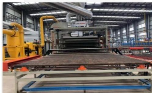
工程渣土处置装备-辊道窑
